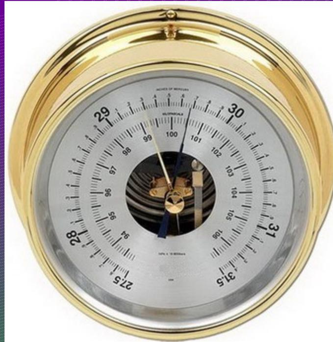
Il mesure la pression atmosphérique, permet d'obtenir des indications sur le temps qu'il va faire. (Il mesure le « poids » de l'air.)
