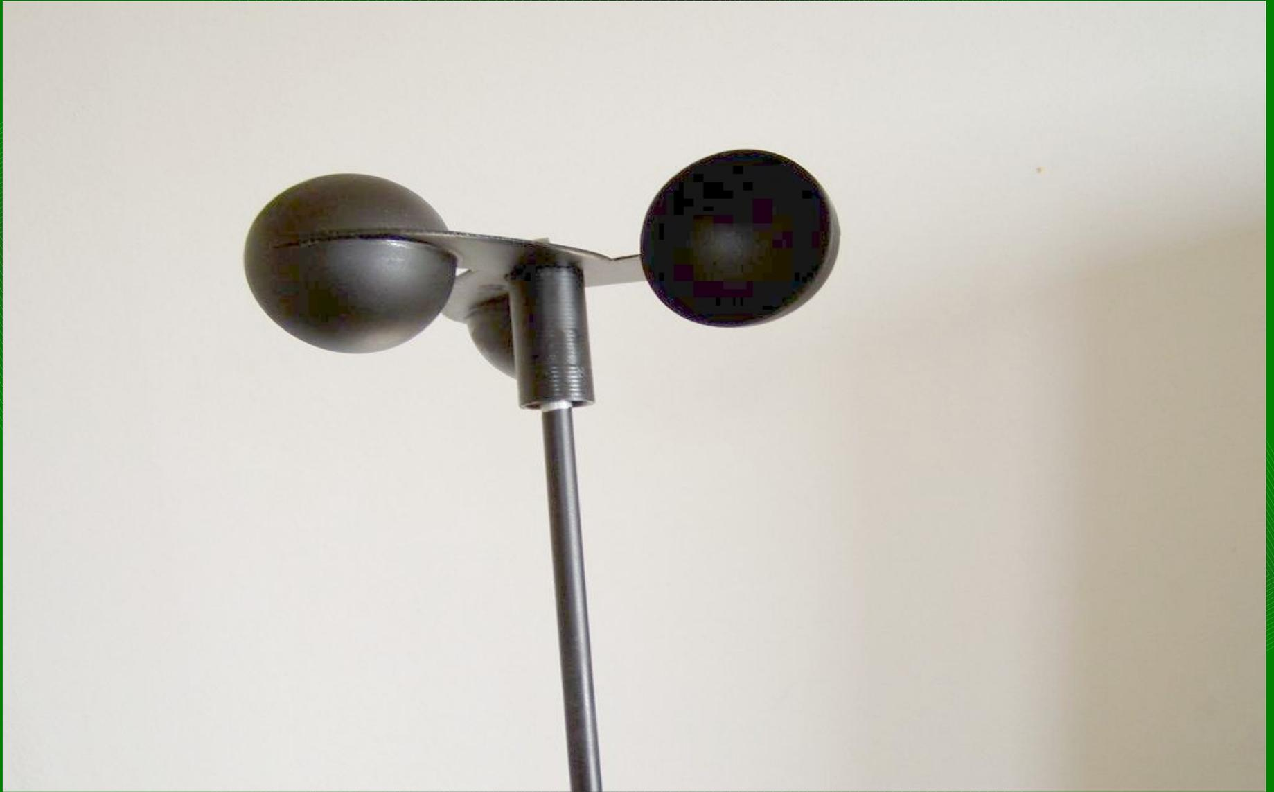
**Les anémomètres mesurent la force (la vitesse) du vent (en noeuds.)**
