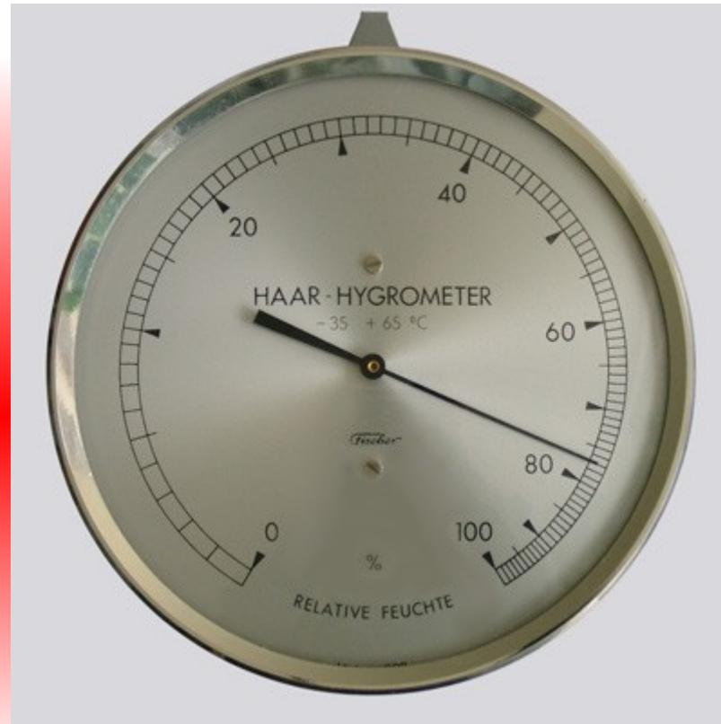
**Instrument pour mesurer le degré d'humidité de l'air.**
